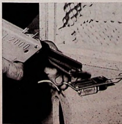
Afb. 15 - Montage van het printje met scheidingsfilter. november 1970
